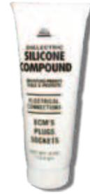
*Aplique bastantes grasas dieléctricas del silicón para cubrir las conexiones del perno y del zócalo de metal de los inyectores. También utilice la grasa de silicón dieléctrica para proteger los conectadores circulares de baja tensión.*
